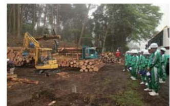
伐倒→集材(スイングヤーダ)→造材(プロセッサ)→積み込み(グラブ)の一連作業を見学
