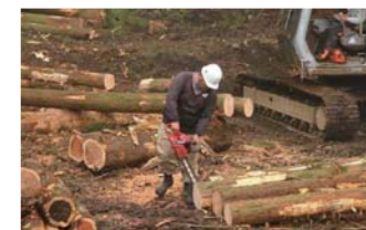
伐倒→集材(スイングヤーダ)→造材(プロセッサ)→積み込み(グラブ)の一連作業を見学
