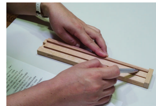
1. 中心線の墨付けをします
